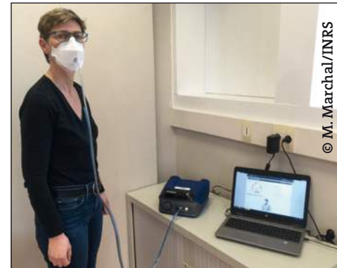
Figure 4 : Montage pour la réalisation d'un essai d'ajustement quantitatif par comptage de particules
