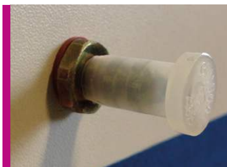
Figure 1. Exemple d'un dispositif permettant de raccorder le tuyau souple relié au micro-manomètre portable pour mesurer la dépression depuis l'extérieur
