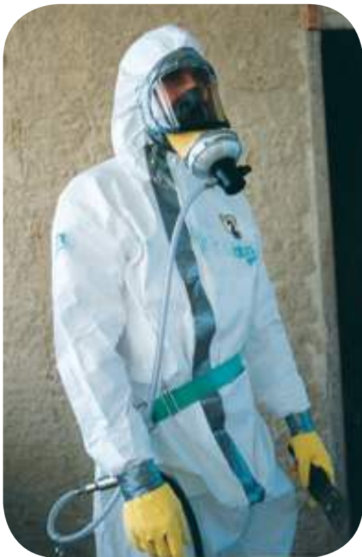
Le système d'adduction d'air comprimé doté d'un filtre P3 monté en série, permettant des débranchements éventuels de courte durée en zone (photo AFPA).
