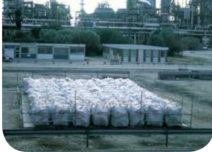
Stockage intermédiaire de déchets en GRV dans une zone surveillée
