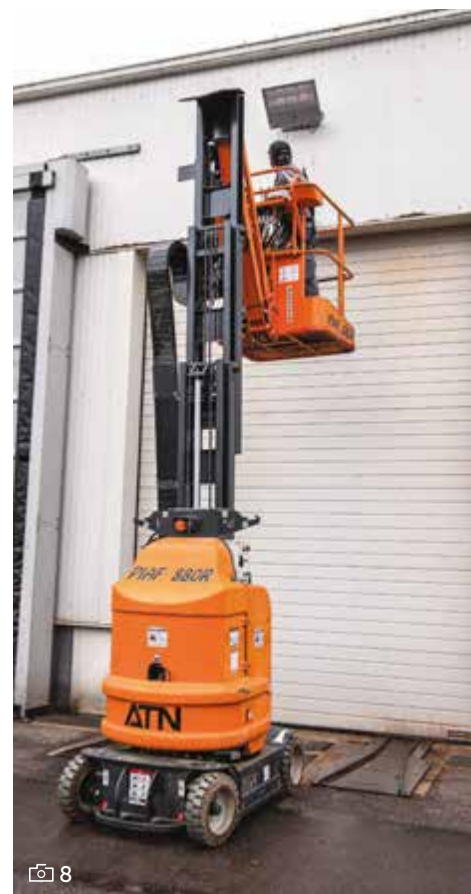
📷 8. UNE NACELLE DE MAINTENANCE à bras déporté est utilisée pour toute intervention sur la chaîne, mais également à l'extérieur, par exemple lorsqu'il faut changer un éclairage. Elle permet de travailler à 8,80 m. Les opérateurs en ont essayé et testé plusieurs avant de faire leur choix.
