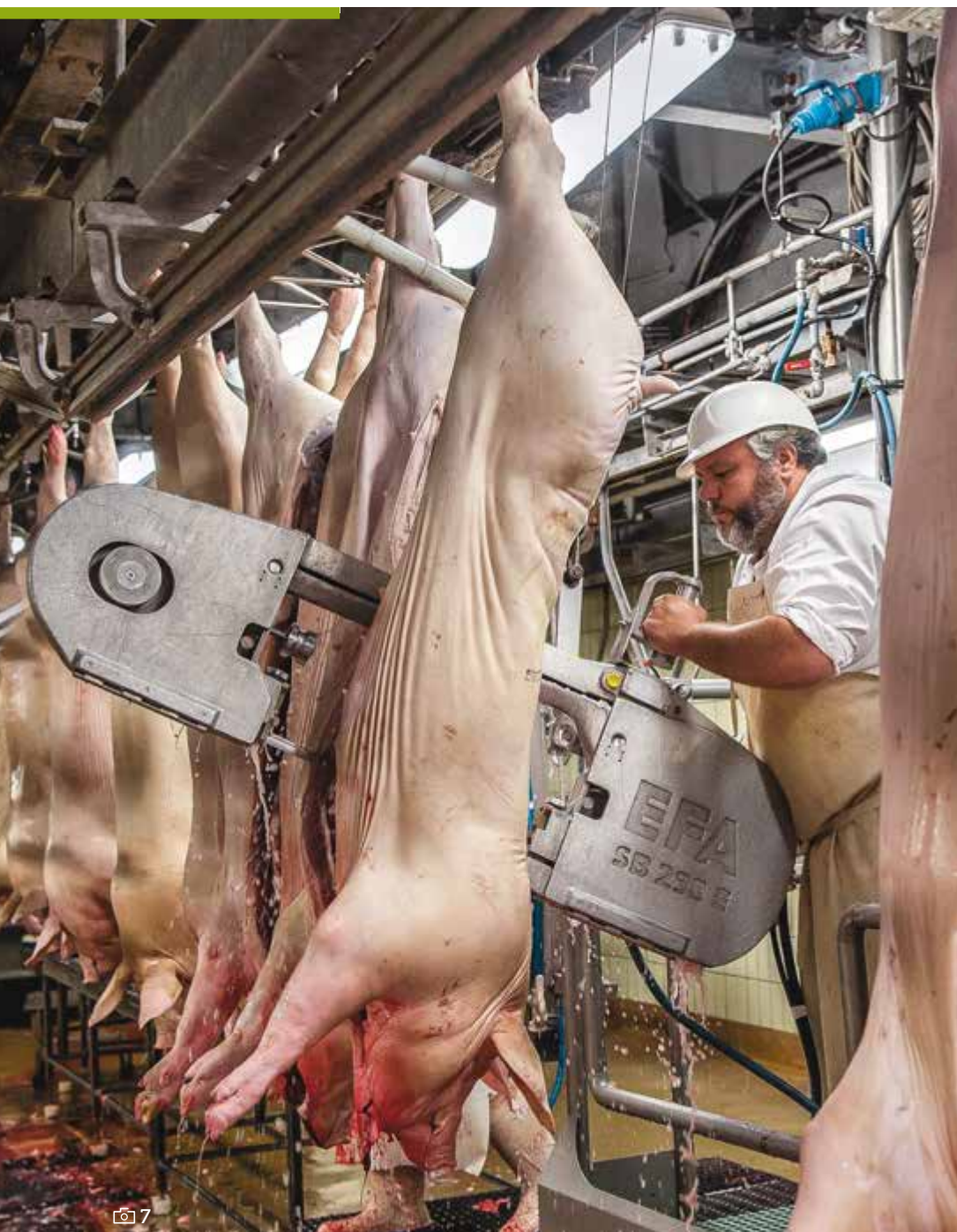
📷 7. GRÂCE À L'INSTALLATION D'UNE PLATE-FORME MOBILE, l'opération de fente du porc peut se faire à hauteur d'homme.
